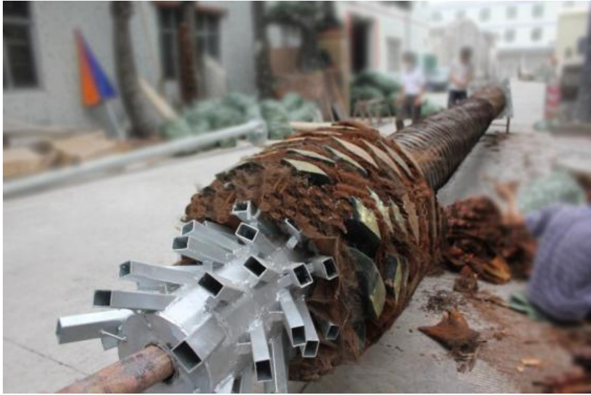
内部结构 Interior structure
